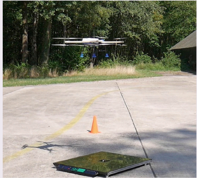
^ De thermische camera en RTK GNSS laten de drone op twee centimeter nauwkeurig landen op het dockingstation.
